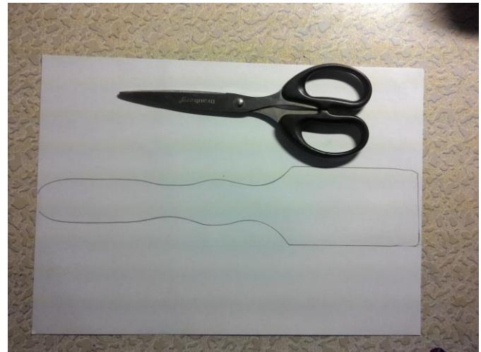
**2.Изготовление шаблона.На белый лист бумаги накладываем кухонную лопатку и простым карандашом обводим её, а за тем ножницами вырезаем полученный шаблон.**
