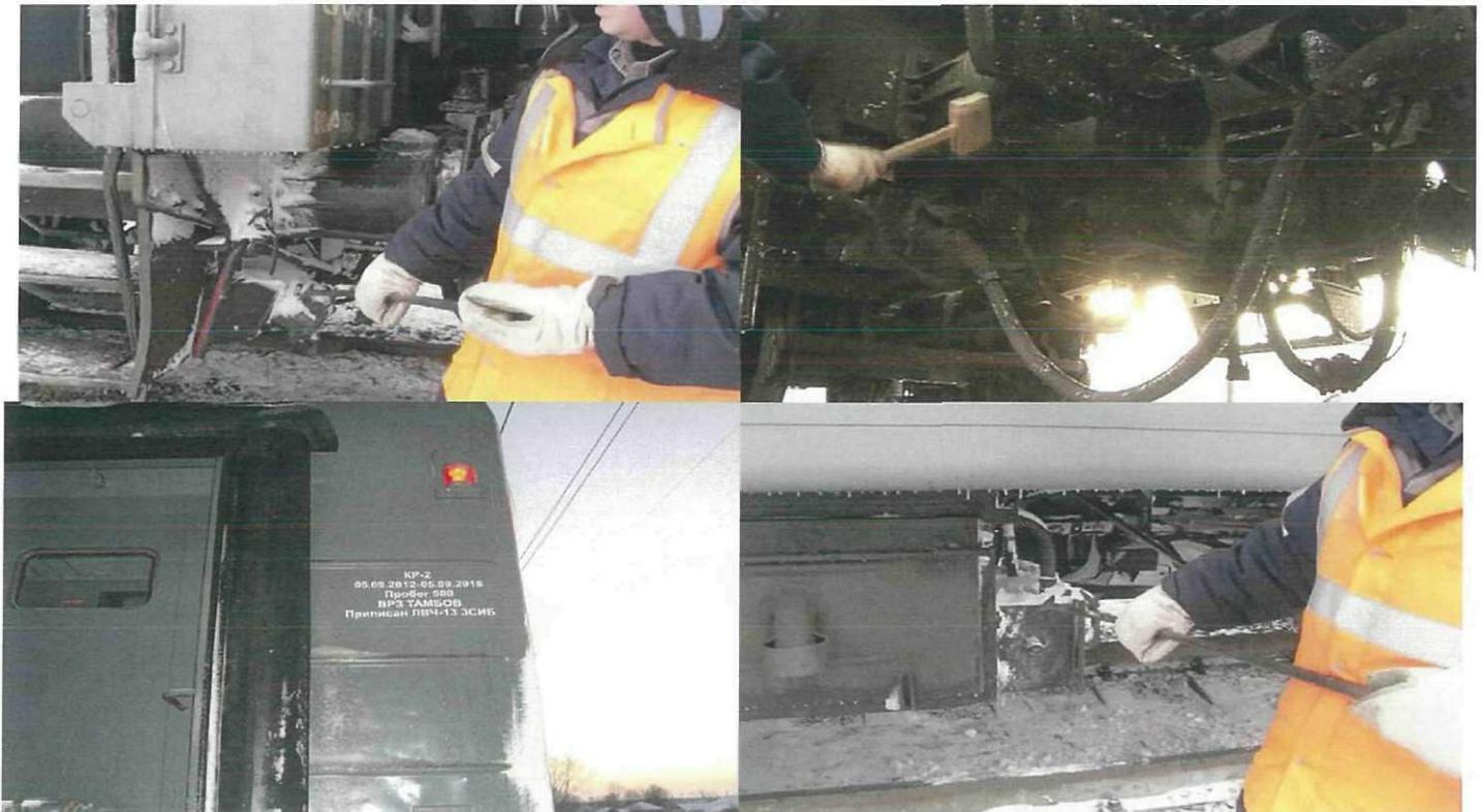
10) Очистку дефлекторов ящиков аккумуляторных батарей производить киянкой или деревянной лопаткой, применять для очистки металлические предметы категорически запрещено
