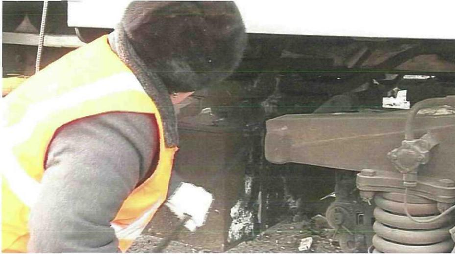
13) Очистка автосцепных устройств и расцепных приводов головного и хвостового вагонов
