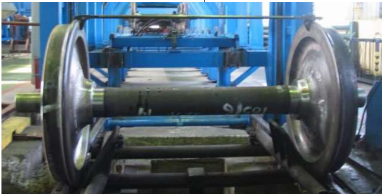
Измерение расстояния между внутренними гранями штангом РВП
