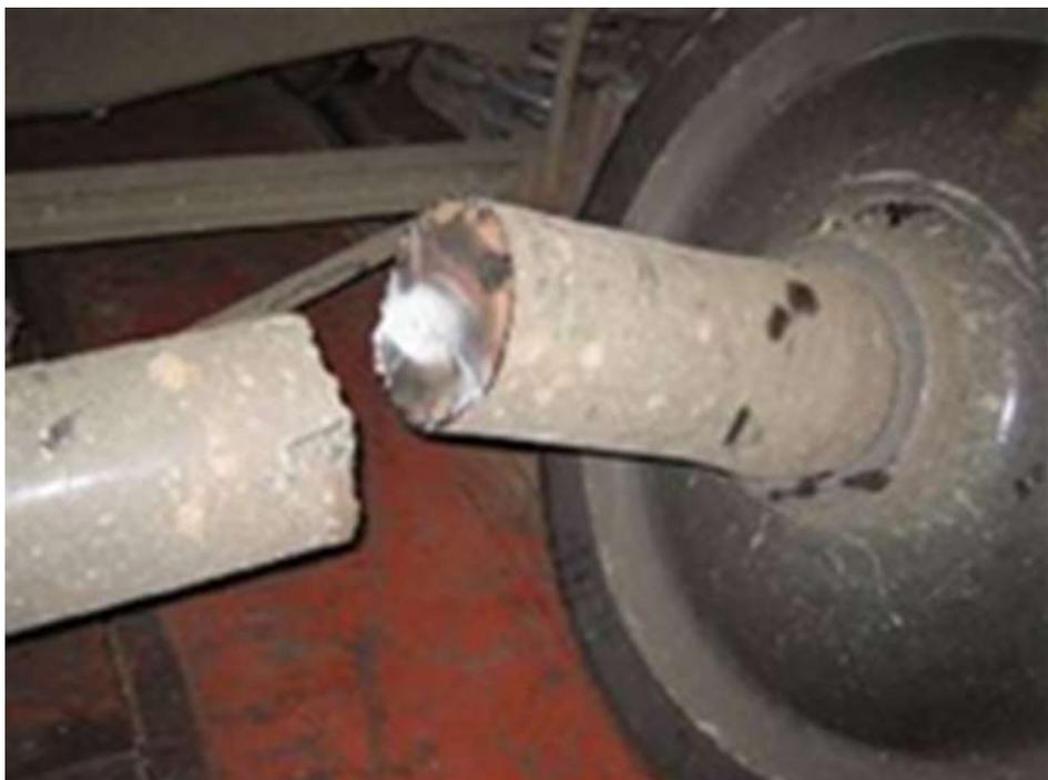
Излом шейки оси из-за перегрев букс
