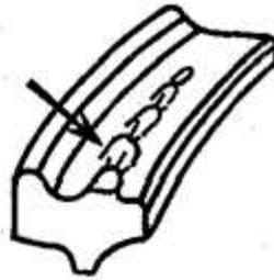
„Навар“ - смещение металла обода колеса высотой более допускаемой
