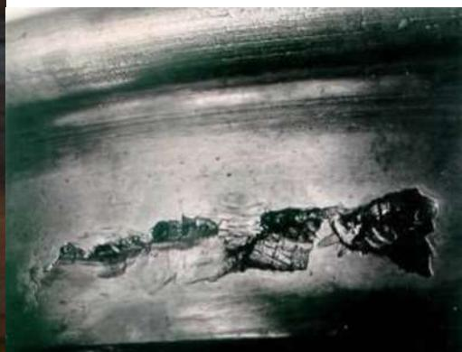
Запрещается выпускать в эксплуатацию вагоны у которых имеются выщербины глубиной более 10мм, длиной П/В – более 25мм, грузовые вагоны – более 50мм. Трещины в выщербины и расслоении металла не допускается.
