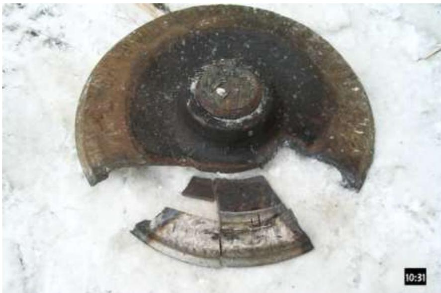
Трещины в колесе:
