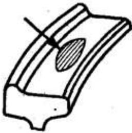
Ползун - плоское место глубиной более допускаемой
