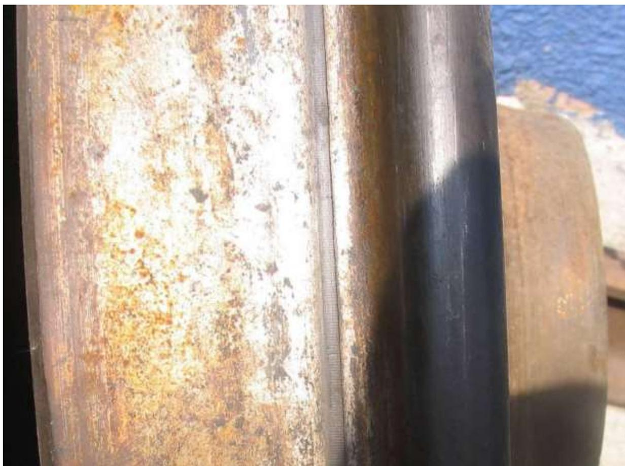
**16. СТУПЕНЧАТЫЙ ПРОКАТ** – это неравномерный по профилю круговой износ, при котором на поверхности катания образуется ярко выраженная ступень. Ступенчатый прокат возникает при смещении пятна катания колеса и рельса в сторону фаски в
