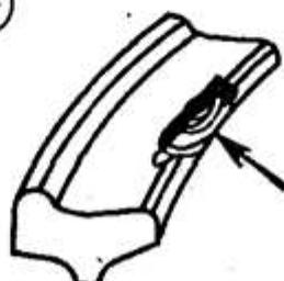
Поверхностный откол у наружной грани обода более допускаемых размеров
