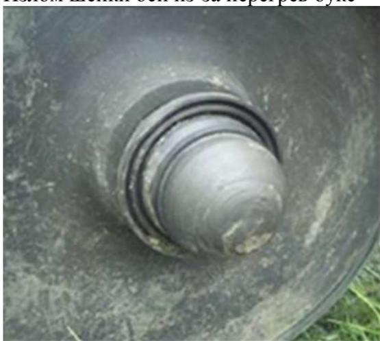
**22. СДВИГ СТУПИЦЫ КОЛЕСА НА ОСИ** – механическое повреждение, которые характеризуются смещением оси ступицы колеса. Это повреждение может быть вызвано нарушениями технологии формирования К/П или ударами при авариях и крушениях.
