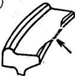
Местное уширение обода - местный наплыв в зоне фаски раздавливание более допускаемого
