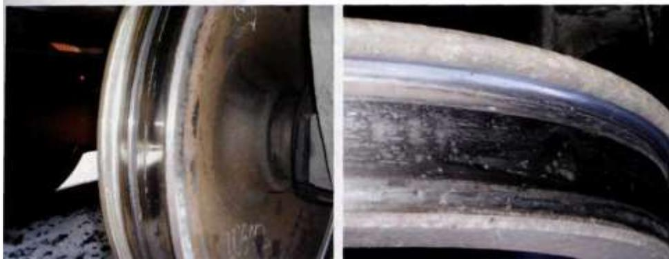
Не допускаются шириной – более 15мм, глубиной – 1мм – 1:20, и 1/7 –более 2мм.
