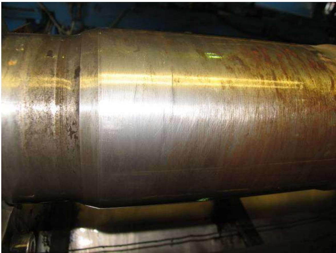
Не допускаются к эксплуатации К/П, имеющие трещины в любой части оси.
