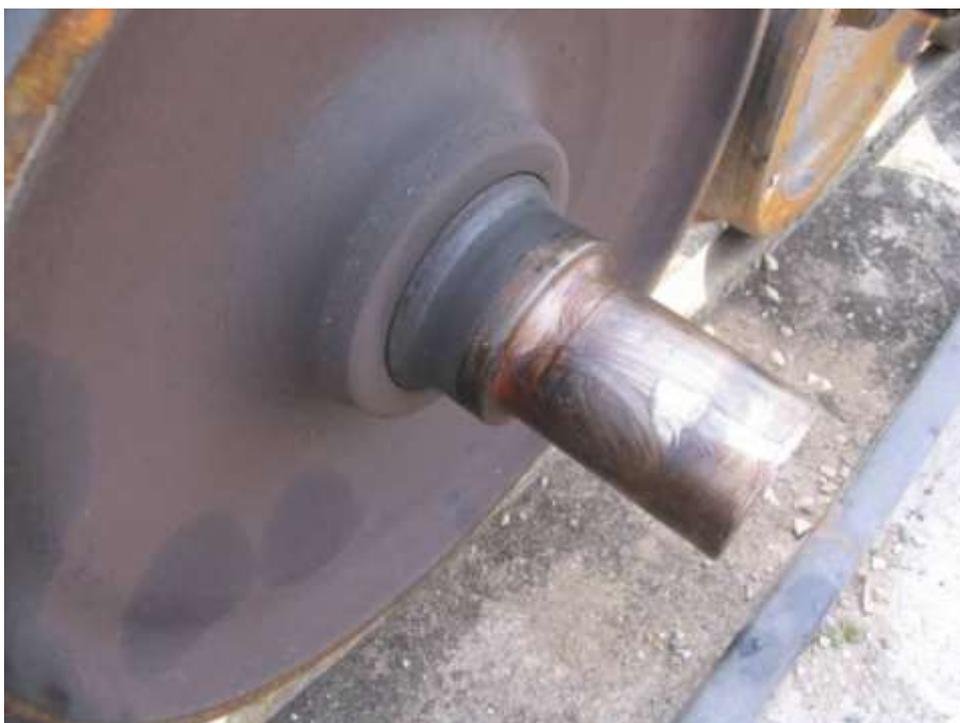
**23 .Изогнутность оси – неисправность возникает от ударов при авариях и крушениях.**
