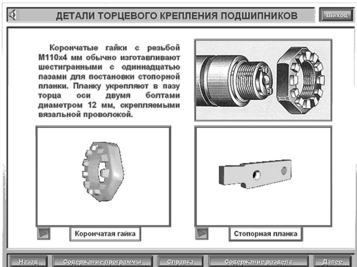
Применяемые подшипники под Г/В и П/В единые- это роликовые подшипники с размерами:
