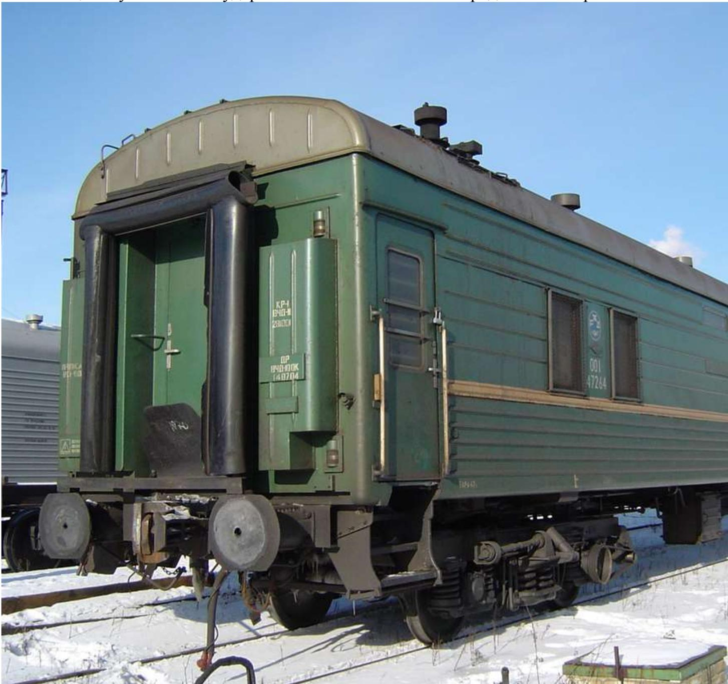
**Автосцепное устройство располагается в концевой части (консольной) хребтовой балки вагона.**
