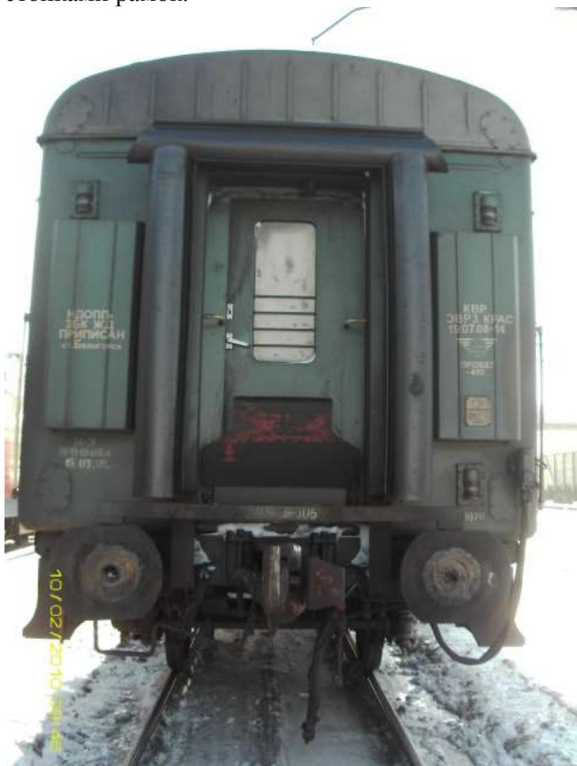
Основными амортизаторами, которые поглощают продольное усилие между вагонами, являются буферные комплекты. Они состоят из буферных стаканов, пружинных комплектов и собственно буферов.
