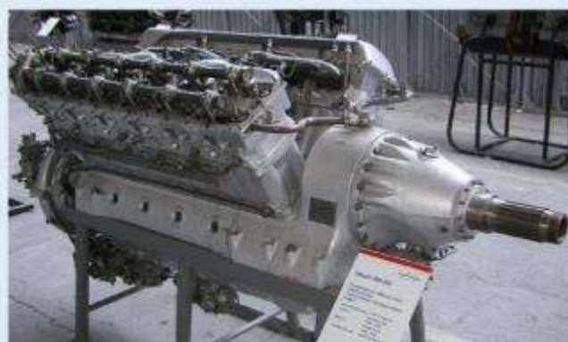
АМ-38 — поршневой, 12-цилиндровый с 60° V-образным развалом цилиндров жидкостного охлаждения, мощностью от 1620 до 1720 л. с., разработан в ОКБ Микулина.
