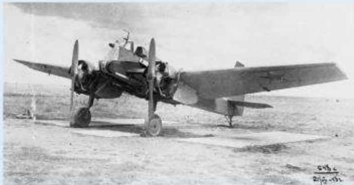
Штурмовик конструктора Д. Л. Томашевича с двигателями М-11
