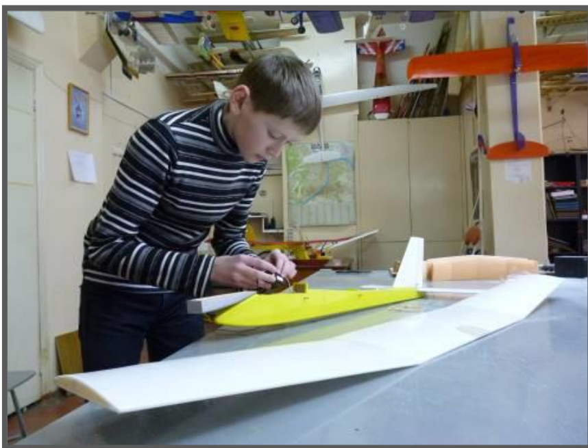
Установка радио - аппаратуры на модель
