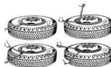
Порядок разборки колеса и демонтажа шины
