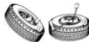
Порядок монтажа шины
