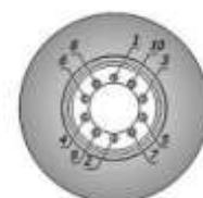
Порядок затяжки гаек колеса
