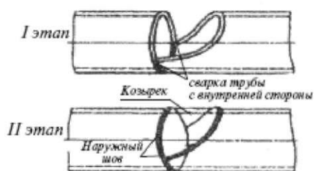
Рис. 109. Порядок сварки стыков труб с козырьком
