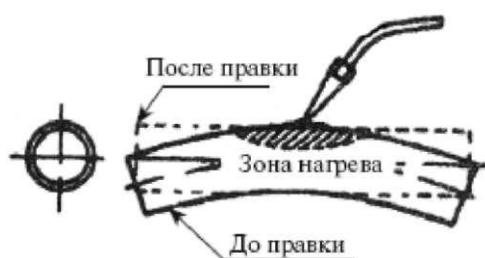
Рис. 103. Правка изделий местным нагревом
