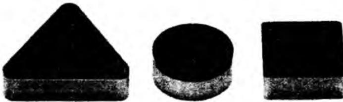
Резец, оснащенный пластиной из синтетического сверхтвердого материала.
