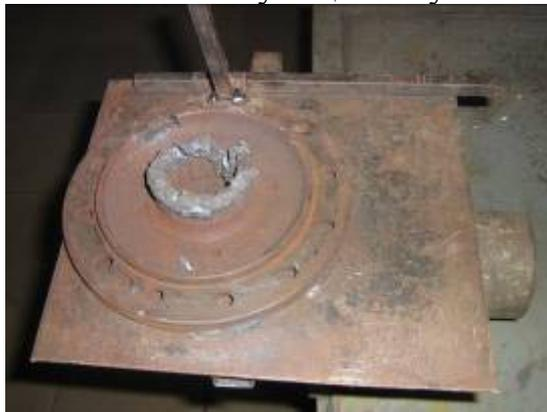
**2 приспособление** изготовлено из труб диаметром 76мм и 57мм приваренных к швеллеру.
