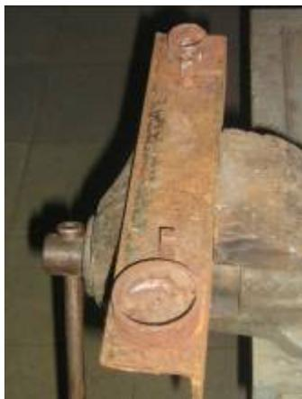
**5 приспособление** заводского изготовления «струбцина» для скручивания квадратного прута размером от 10X10мм до 14X14 мм (причём длина прутка может быть любой)■
