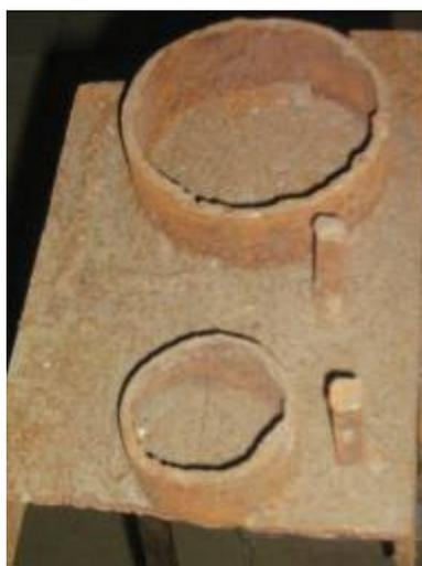
**3 приспособление** полукруглый сегмент, приваренный к листу железа 30X30 толщиной 3мм.
