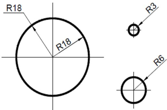
Рис.9. Нанесение размера радиуса
