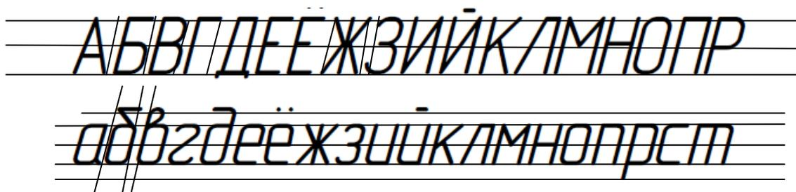
Рис.3. Упрощенная вспомогательная сетка
