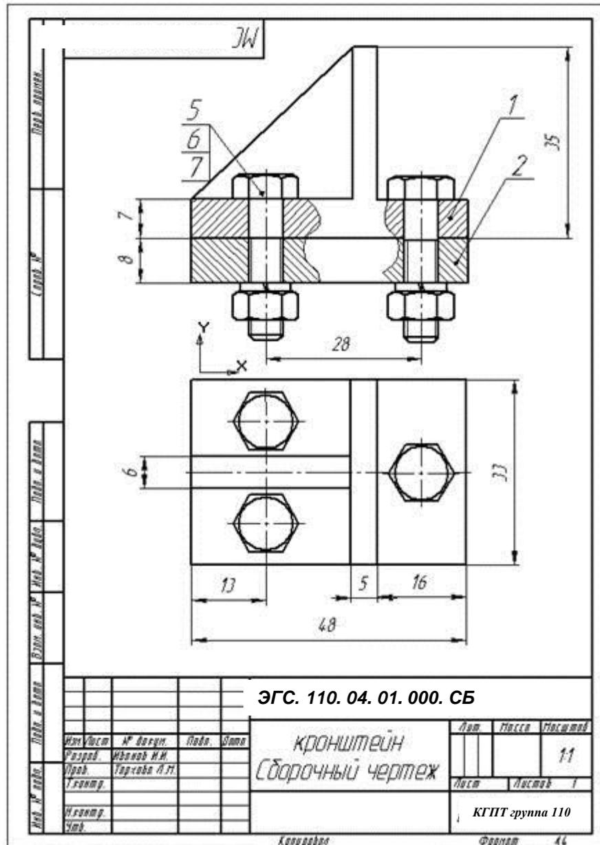
Рис.17. Пример выполнения сборочного чертежа Задание4\_Формат А4 (Расчетно-графическая работа №3)
