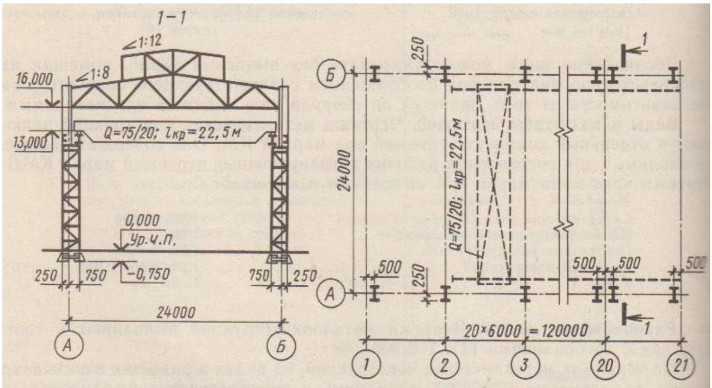
Рис.19 Схематический чертеж (план и разрез) производственного здания
