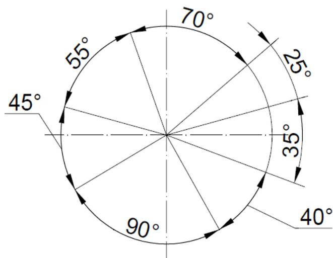
Рис.8. Нанесение размеров углов
