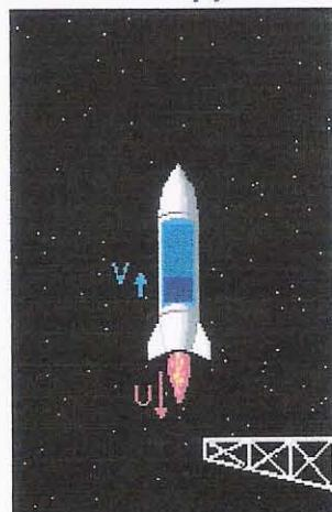
Реактивное движение основано на *принципе отдачи*. В ракете при сгорании топлива газы, нагретые до высокой температуры, выбрасываются из сопла с некоторой скоростью  $\bar{U}$ . Ракета и выбрасываемые газы взаимодействуют между собой. Если первоначальную массу ракеты обозначить через  $M_0 = m + M_{fuel}$ , а массу выброшенных газов через  $m_g = M_0 - M$ , то скорость ракеты на основании закона сохранения импульса окажется равной
