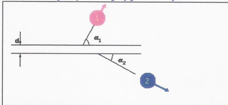
Упругое нецентральное соударение между двумя бильярдными шарами может служить примером двумерного соударения. В этом случае один из шаров имеет некоторую первоначальную скорость  $\vec{v}$ , а другой находится в покое. Расстояние  $d$  между прямой, вдоль которой направлена скорость первого шара, и центром второго шара называется *прицельным расстоянием*. Это расстояние служит мерой отличия нецентрального соударения от центрального;  $d=0$  соответствует центральному соударению.
