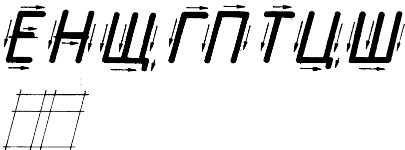
Рис. 35. Начертание прописных букв, состоящих из горизонтальных и вертикальных элементов, и построение вспомогательной сетки
