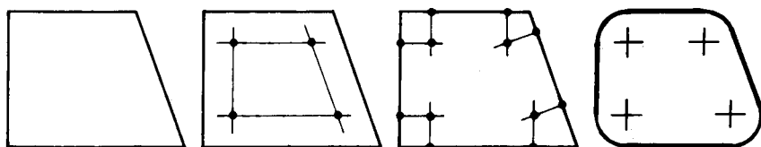
Рис. 60. Сопряжение углов на примере построения проекции боковой стенки хлебницы
