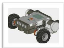
**Соберите базовую модель робота-автомобиля, используя сборник инструкций. Подключите к блоку NXT левый мотор в порт В, правый мотор – в порт С.**
