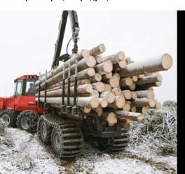
Отличная устойчивость, благодаря уникальной конструкции центрального шарнира с управляющим сочленением в передней раме и поворотным шарниром в задней раме.
