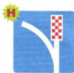
Полоса для аварийной остановки
