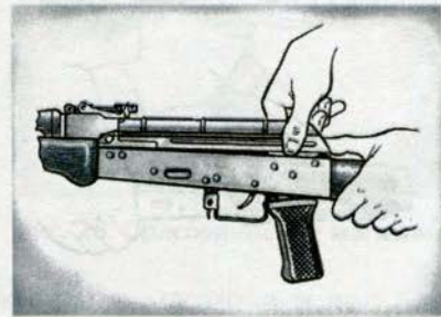
Рис. 20. Отделение крышки ствольной коробки
