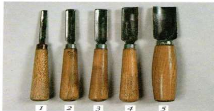
Рис. 52. Стамески отлогие (полуплоские) узкие 4–7 мм (1) и широкие: 10–12 мм (2); 18 мм (3); 20 мм (4); 25 мм (5)
