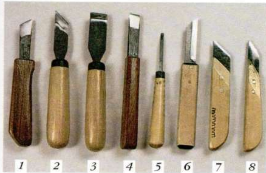
Рис. 50. Стамески: прямые со скосом (1, 2), прямые узкие и широкие (3–5). Ножи: богородский (6), со скосом 45^\circ (7) и 35^\circ (8)
