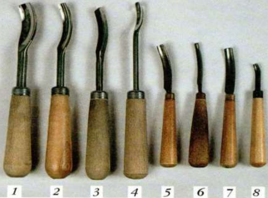
Рис. 53. Клюкарзы: отлогие (1, 2, 4), уголок (3), полукруглые крутые (5–8)
