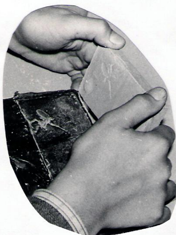
6. Завершение изготовления первой полуформы.
